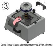
Utilizando uma lixa fina 200 a 400 nos anéis dourados
